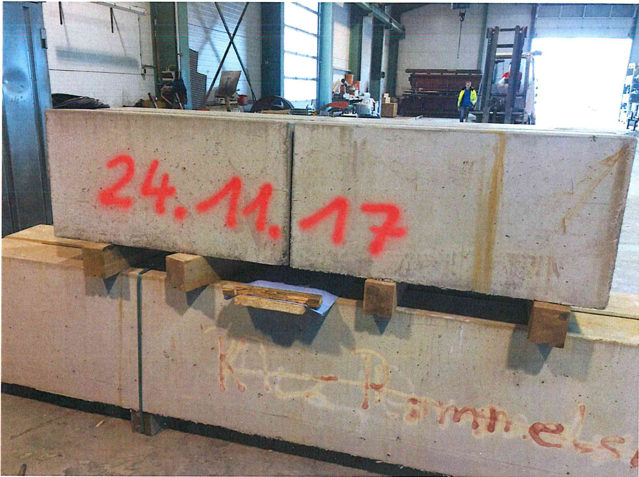
Bild 1. Profil 2 wurde auf Dichtigkeit (drucklos) überprüft.
